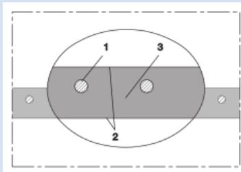
Antistatischer Lebensmittelschlauch und Pharmaschlauch, superschwer, innen und außen glatt, Edelstahlbraht (INOX)
