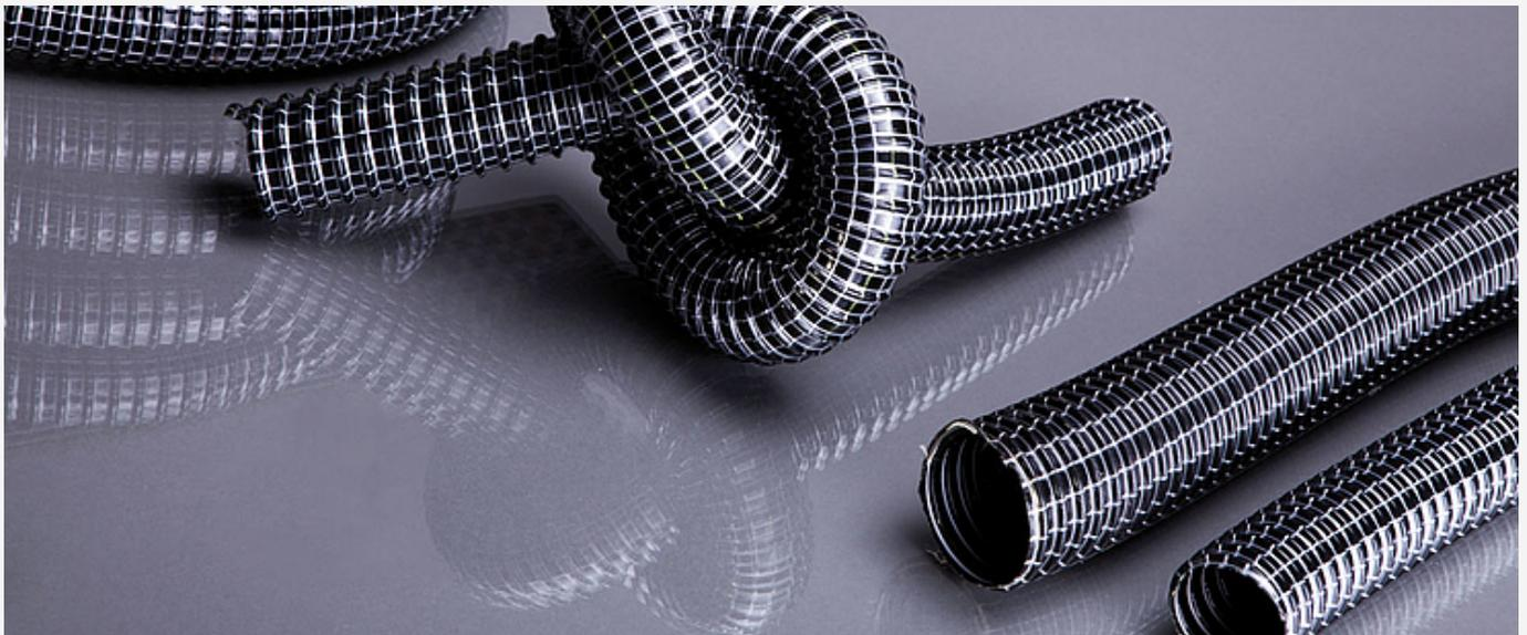
Leichter und sehr flexibler PVC-Schlauch mit Federstahlspirale und Fadenverstärkung. Die Fadenverstärkung reduziert deutlich die Längendehnung und erhöht die Druckfestigkeit. Die glatte Seele erhöht die Durchflussmenge des Mediums. Geeignet für eine Vielfalt von chemischen Substanzen. Geschützt vor Witterungseinflüssen.
