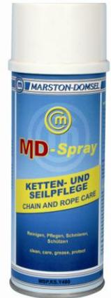
**MD-Ketten- & Seilpflege-Spray** ist ein vollsynthetisches, transparentes und dünnflüssiges Ketten- und Seilpflege-Spray mit hoher Kapillarwirkung und Langlaufschmierung, durchdringt Ketten und Drahtseile auch von innen heraus bei einer Kälte- und Wärmebeständigkeit von -15°C bis +250°C.
