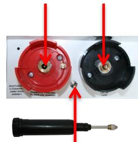
Bei der Verwendung von OKS Ölen ohne Lösemittel ist eine Nachschmierung normalerweise nicht notwendig.
