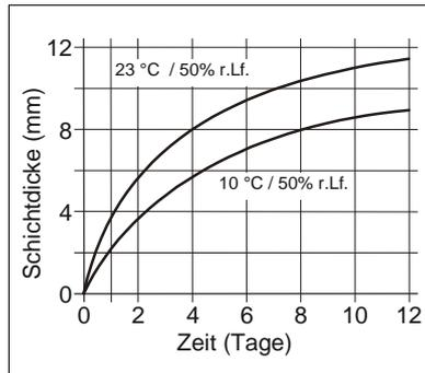
Diagramm 1: Durchhärtungsgeschwindigkeit für Sikaflex®-527 AT
